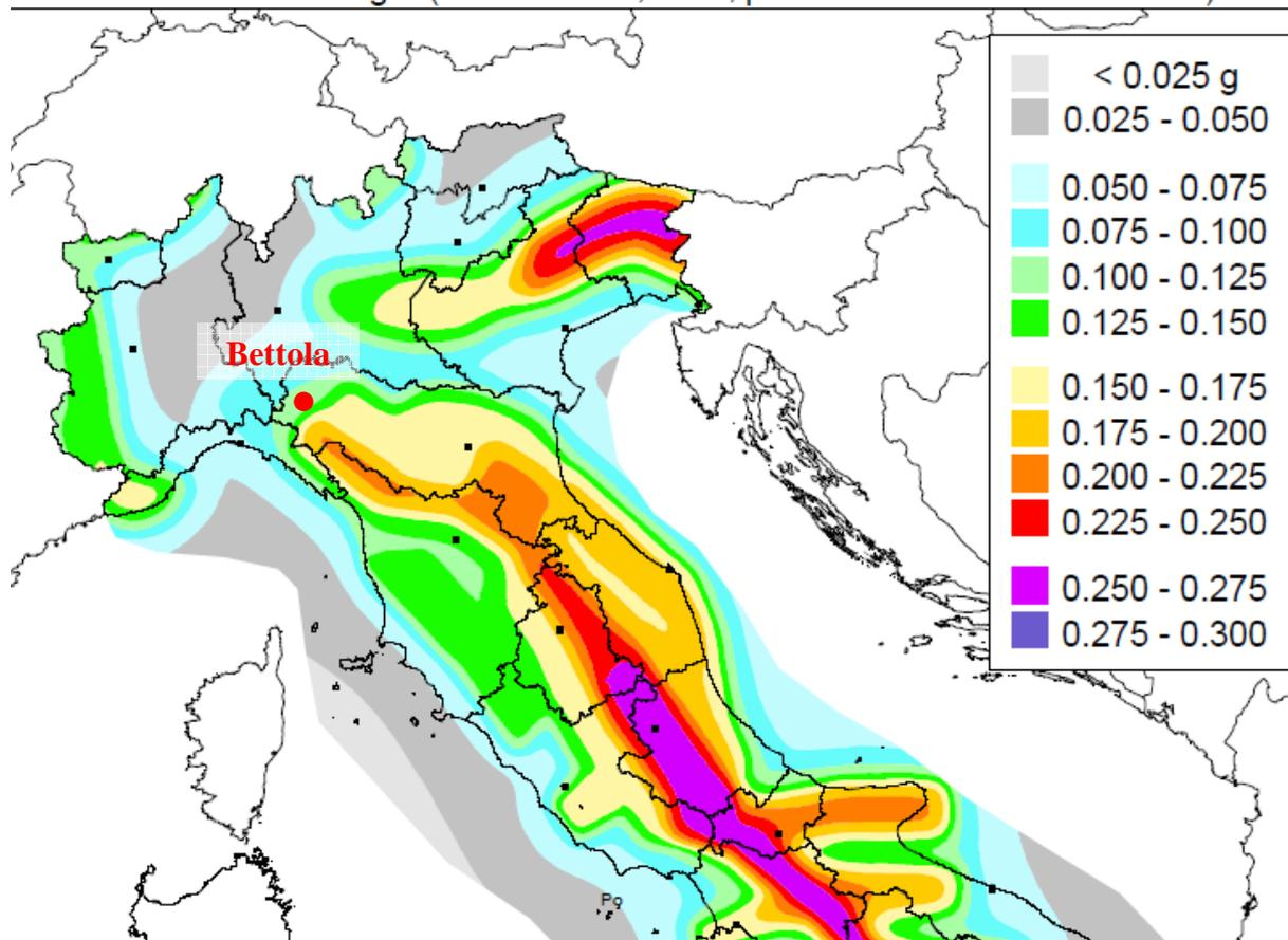
**Figura 4 – Stralcio della Carta della Pericolosità Sismica di Riferimento, secondo OPCM 3519/2006, espressa in termini di accelerazione con probabilità di eccedenza del 10% in 50 anni riferita ai suoli rigidi.**
